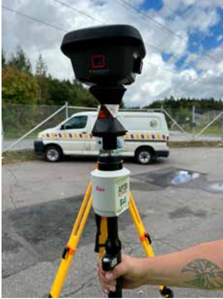
Uudessa mittalaitteessa on mm. kallistusmittaus- ja kuvastamittausmahdollisuus. Kuva Jyrki Ristilä.
