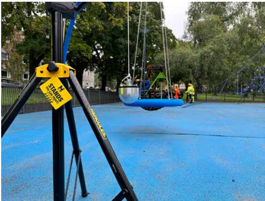
Infran leikkipaikkatarkastajilla on vuosien kokemuksen lisäksi käytössään HIC-laite, jolla testataan turva- alustojen toimivuutta ja sopivuutta. HIC-laite mittaa alustan iskunvaimennuskykyä ja sillä voidaan testata kaikkia eri turva- alustoja. Kuva Jyrki Ristilä
